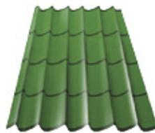
Новое оборудование позволяет прокатывать металлочерепицу в большом количестве вариаций. Длина волны может варьироваться в пределах от 300 до 500 мм (с шагом 10 мм), а высота профилирования может составлять 10, 15 или 23 мм. Благодаря этому заказчик имеет возможность выбора из 60 вариантов. Применение станка гарантирует безупречное профилирование – продольные и поперечные швы на крыше практически незаметны, что улучшает внешний вид кровли, а также свидетельствует о ее герметичности.
