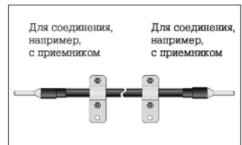
Рис. 6. Готовые токоотводы в изоляции высокого напряжения с различными концами и скобами для монтажа [2]
