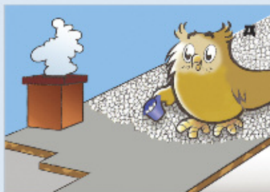
д) нанесение гравийной засыпки
