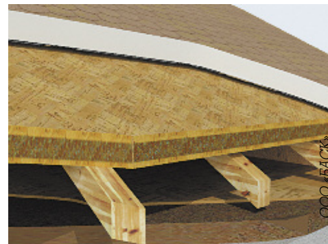
Применение пробковых панелей в качестве основы под кровельное покрытие из гибкой черепицы
