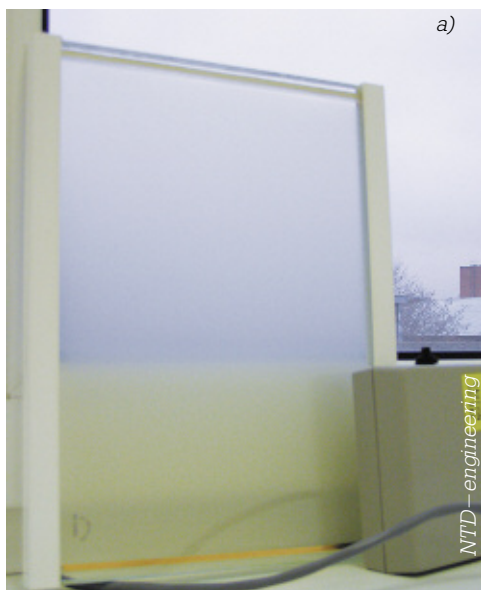
Образец «переключаемого» стекла: а) режим «матовое», б) режим «прозрачное»
