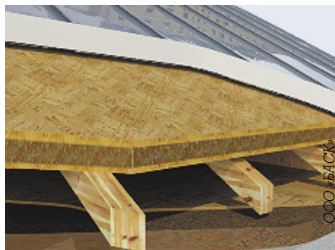
Применение пробковых панелей для тепло- и звукоизоляции скатных кровель с металлическим фальцевым покрытием
