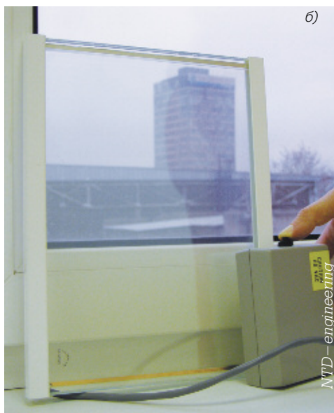
Образец «переключаемого» стекла: а) режим «матовое», б) режим «прозрачное»
