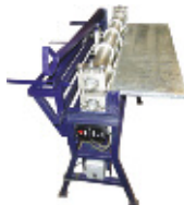
Механический станок для резки металла СПР-1250/3-Р: толщина реза – до 0,8 мм; макс. ширина полосы – 1250 мм; количество пар ножей – 3; масса – 52 кг
