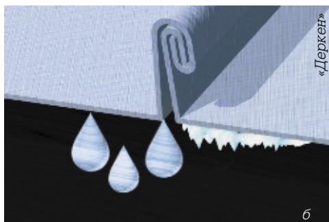
Функции структурной разделительной мембраны: а, б, в – отвод конденсата и вентиляция подкровельного пространства; г – компенсация температурных деформаций
