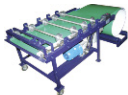
Компактный кровельный станок СФП-700: высота фальца – 25 мм; производительность – 5 м/мин; ширина полосы – 250–700 мм; толщина металла – до 0,7 мм; масса – 140 кг; электрическая мощность – 0,75 кВт
