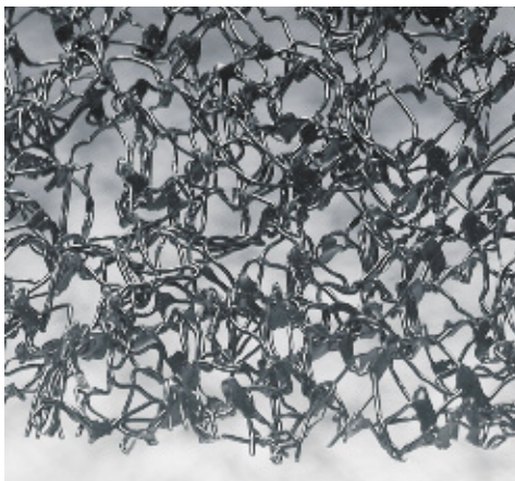
Неориентированная мембрана. Структура низкого качества: спайки нитей могут создавать препятствия для отвода конденсата и привести к коррозии цинка
