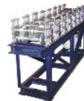
Станок для производства Омега-профиля (шляпного) СПО-15: производительность – 10 м/мин; толщина металла – до 1,5 мм; масса – 250 кг; электрическая мощность – 1,5 кВт
