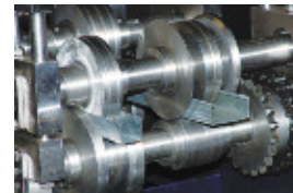
Станок «Мобипроф» ГК для производства профилей «Кнауф»: производительность – 10 м/мин; толщина металла – 0,45–0,60 мм; масса – 500 кг; электрическая мощность – 2,2 кВт
