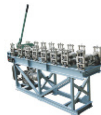
Станок для производства Омега-профиля (шляпного) СПО-15: производительность – 10 м/мин; толщина металла – до 1,5 мм; масса – 250 кг; электрическая мощность – 1,5 кВт
