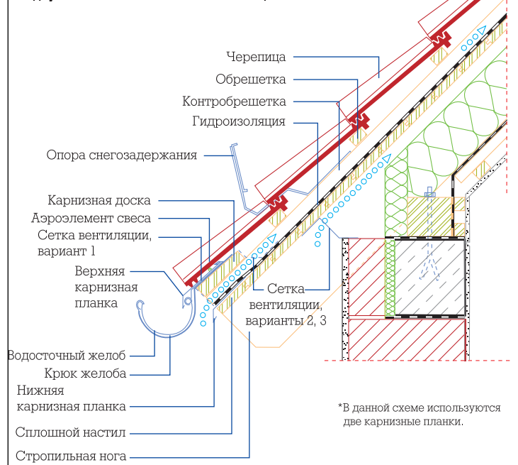
Схема 2 Карнизный свес утепленной кровли с двухканальной системой вентиляции*
