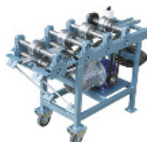
Станок для производства С-профиля СПС-15 в комплекте с ручной гильотиной: производительность – 10 м/мин; толщина металла – до 1,5 мм; масса – 350 кг; электрическая мощность – 2,2 кВт
