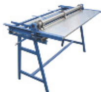
Электромеханический станок для резки металла СПР-1250/5-А: толщина реза – до 1,5 мм; ширина полосы – 1250 мм; количество пар ножей – до 15; масса – 250 кг; электрическая мощность – 0,55 кВт
