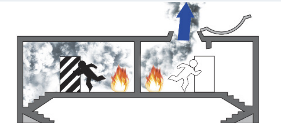
Отведение дыма и газов, возникающих при пожаре
