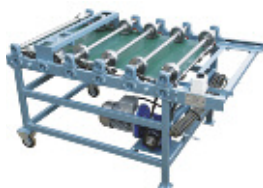
Компактный кровельный станок СФП-700: высота фальца – 25 мм; производительность – 5 м/мин; ширина полосы – 250–700 мм; толщина металла – до 0,7 мм; масса – 140 кг; электрическая мощность – 0,75 кВт
