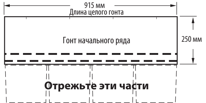
Рис. 14-5. Изготовьте гонты начального ряда, отрезав 20,3 см язычки.
