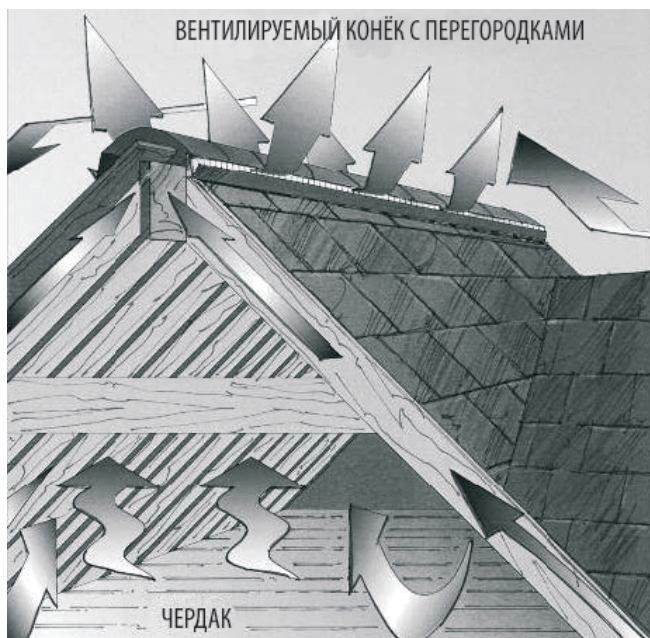
Рис. 7-12. На крышах L-образной и T-образной формы вентиляционные секции должны быть размещены как вдоль длинных, так и вдоль коротких коньков, поскольку все зоны чердачного помещения сопряжены друг с другом. Если высота коньков отличается более чем на 1 м, то вентилируемым должен быть только самый высокий конёк, либо установите перегородки в чердачном помещении.
