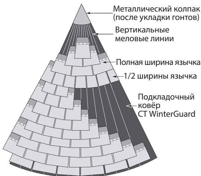
Рис. 9-6. Укладка гонта на округлённую часть крыши.
