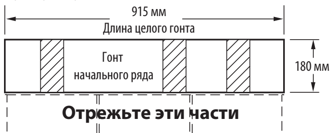
Рис. 13-8. Изготовьте гонты начального ряда, отрезав 5-дюймовые язычки.
