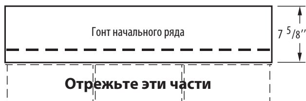
Рис. 12-6. Высота гонтов должна составлять не менее 194 мм.
