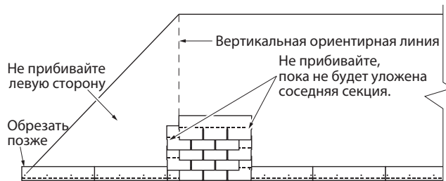
Рис. 9-5. Вертикальная секция гонта.
