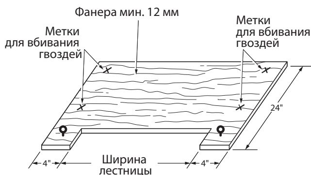
Рис. 1-1: Фанерный щит водосточного жёлоба.
