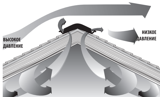
Рис. 7-9. Ветер, проходящий над вентилируемым коньком ShingleVenf II с перегородками, создаёт низкое давление на
