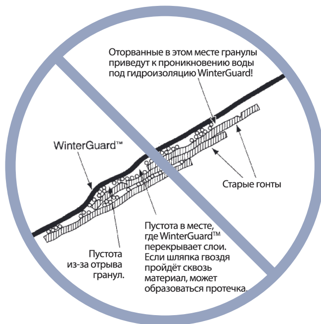
Рис. 5-4. Проблемы, возникающие при укладке WinterGuard на крышу.
