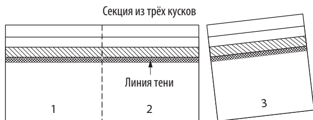
Рис. 12-18. Разделите, чтобы получить 3 покрывающих гонта.
