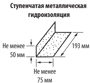
Рис. 12-10. Минимальные размеры ступенчато гидроизоляции.
