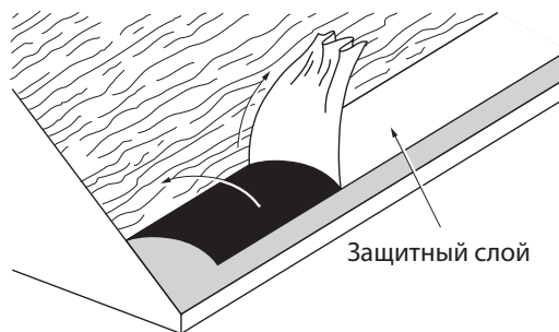
Рис. 5-6. Укладка методом «задираия и прижима».
