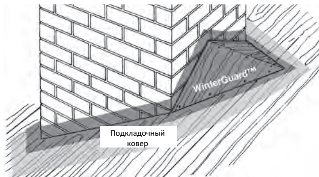
Рис. 6-8: Дымоход через настил крыши.
