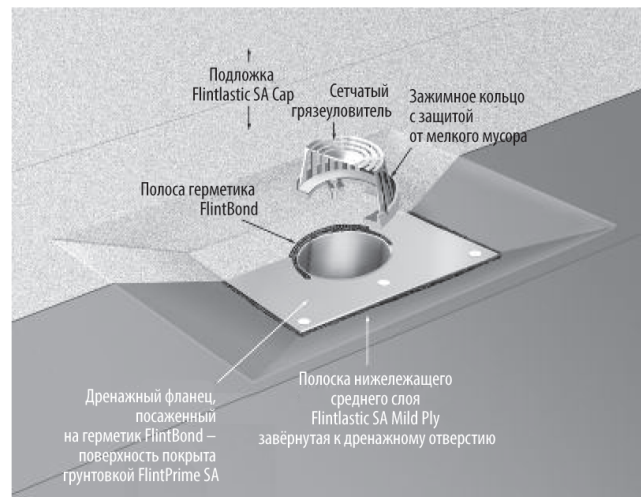
Рис. 5-36. Дренаж в трёхслойной системе.
