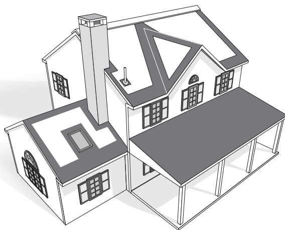
Рис. 7-6. Области, закрашенные темным цветом - участки, защищенные системой WinterGuard от проникновения талой вод, образующихся в результате таяния снега и льда.
