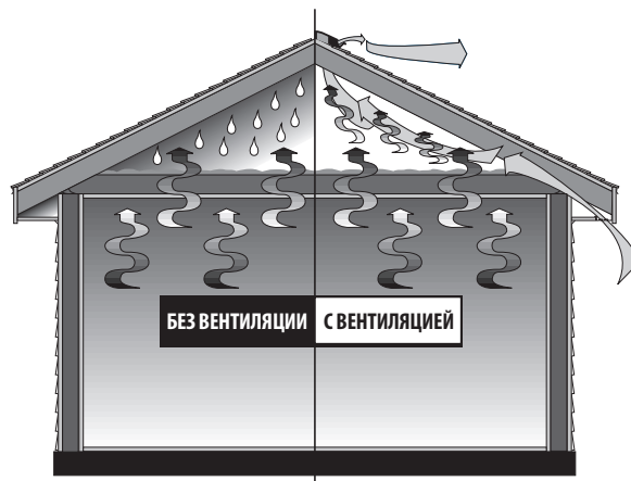
Рис. 7-8. Вентиляция чердачного помещения за счёт теплового эффекта.
