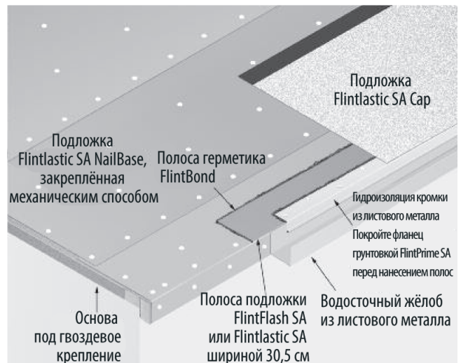
Рис. 5-30. Конструктивные особенности водосточного жёлоба в двухслойной системе.
