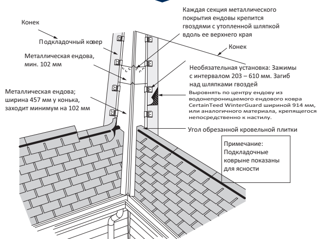
Рис. 6-20: Типичная закрепленная кляммерами открытая ендова
