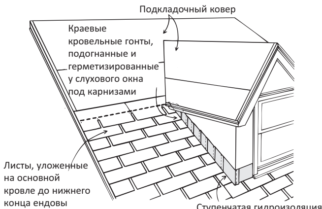
Рис. 6-4: Гидроизоляция фронтальной/боковой стены.
